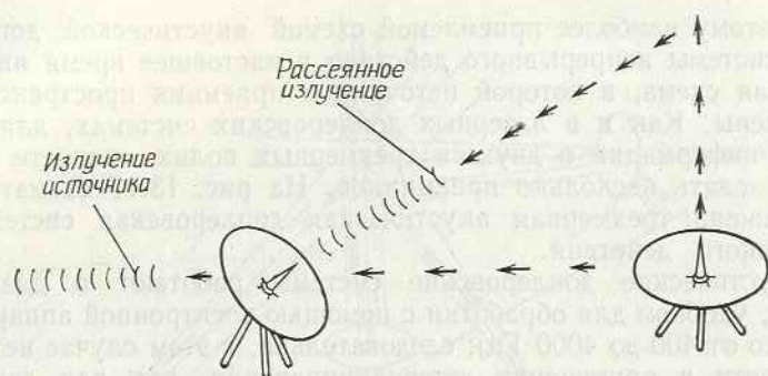
Рис. 13.18. Схема исключения вредного влияния излучения источника путем применения импульсной акустической доплеровской системы.
